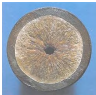
Silne zanesené ocelové potrubie
