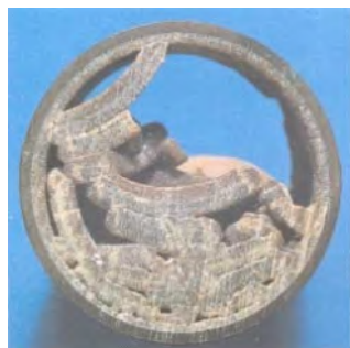
Medené potrubie zanesené vodným kameňom
